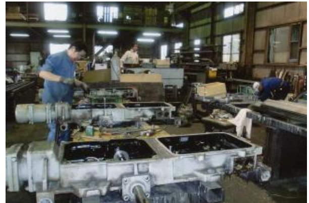
転輸機のオーバーホール作業
