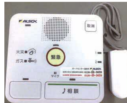
緊急通報システム
