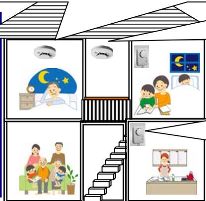
〈階段〉寝室が2階や3階の場合は、階段の踊り場の天井か壁面に設置します。
