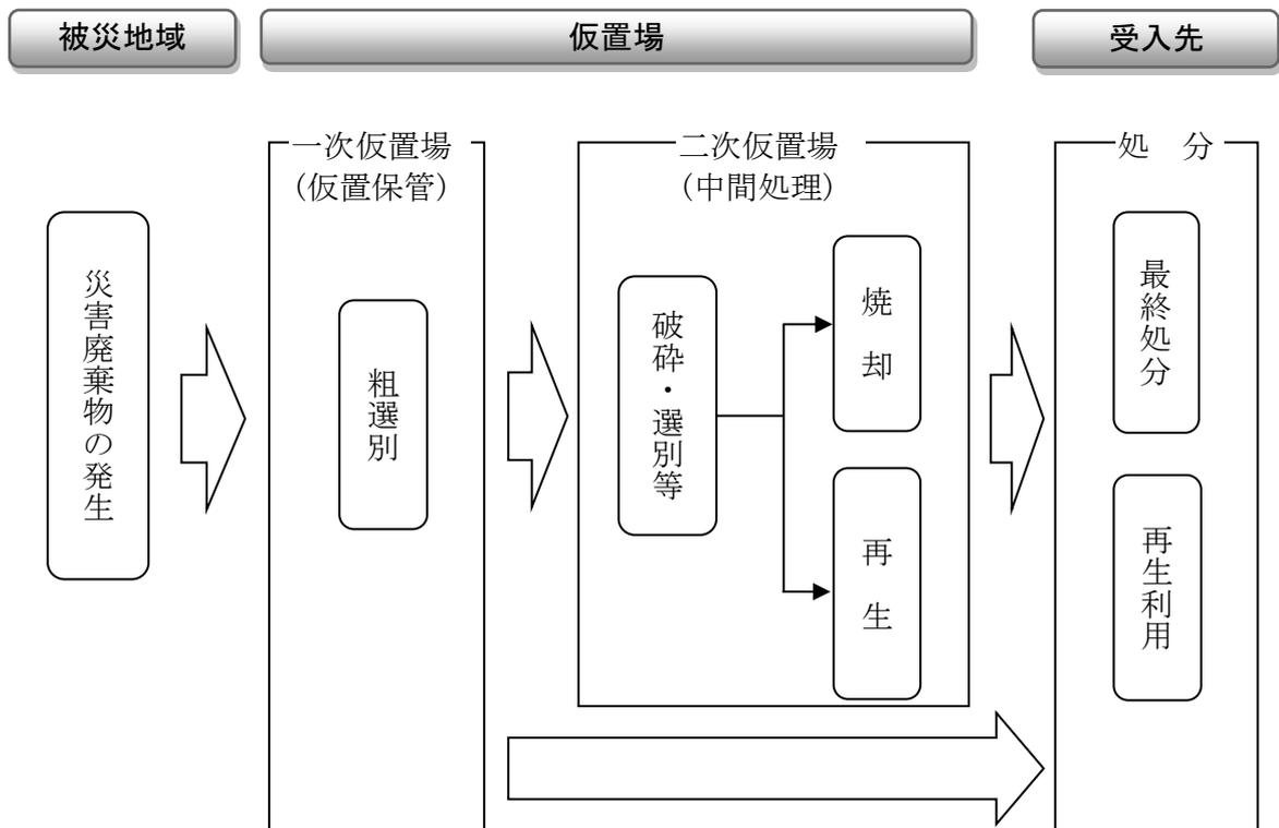
図1-9 災害廃棄物の処理の全体の流れ
