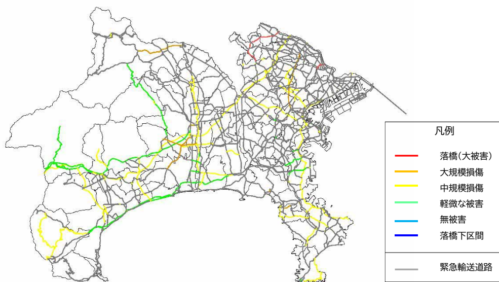
図 都心南部直下地震が発生した場合の橋梁がある緊急輸送道路の損傷想定
