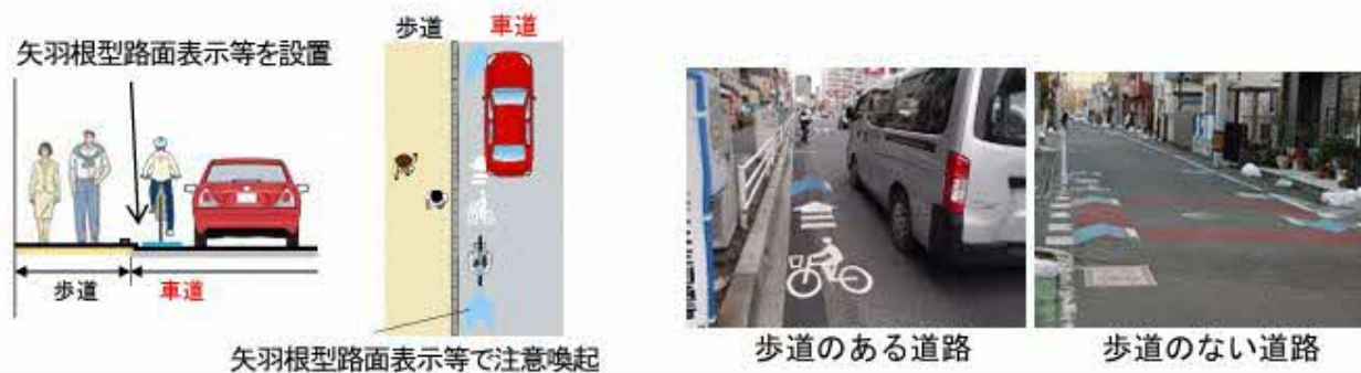
図 自転車道・自転車専用通行帯・矢羽根型路面表示の整備イメージ
